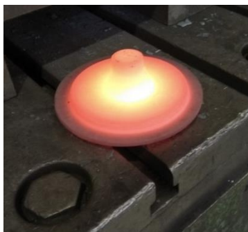
Рис. 3. Штампованная поковка «Фланец» из стали 08X18H10T
