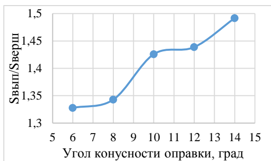
Рис. 3. Зависимость параметра S_{вып}/S_{верш} от угла конусности оправки
