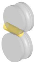
Рис. 2. Трехмерная модель раскатного стана представлена
