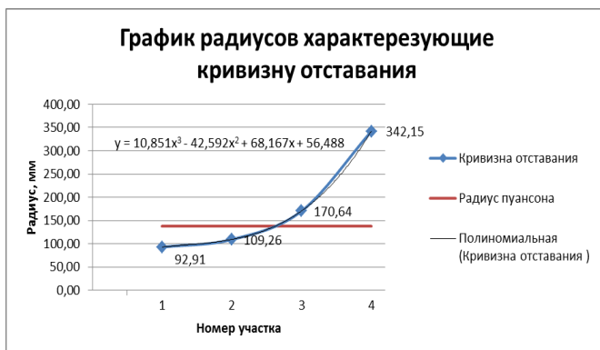
Рис. 2. График изменения радиусов кривизны в зоне отрыва заготовки
