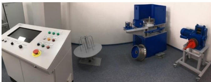
Рис. 1. Однократный волочильный стан
