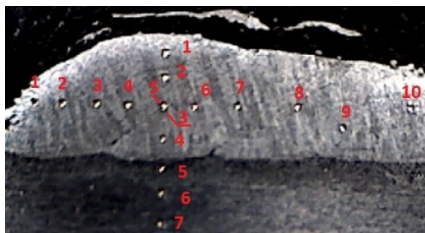
Рис.2. Схема измерения микротвердости (x50)
