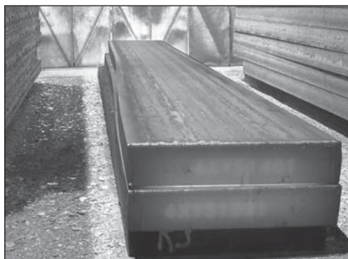
Рис. 6. Уменьшение ширины сляба на 200 мм (с 1300 до 1100 мм) на коротком участке длиной всего 6,3 м
