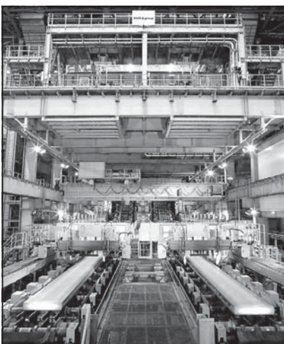
Слябовая УНРС для производства высокомаржинальных марок сталей на комбинате в Авилесе Фото: SMS group
