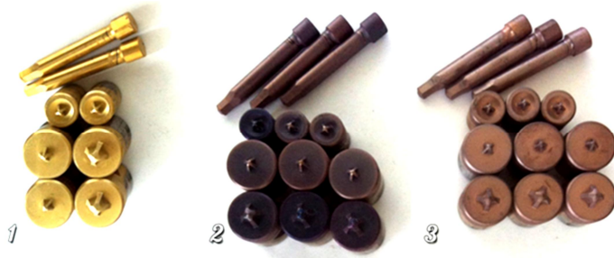
Рис. 1. Фотографии штампового инструмента с различными покрытиями: 1 – азотирование + TiN ; 2 – азотирование + Ti-TiAlN ; 3 – азотирование + Ti-TiCN
