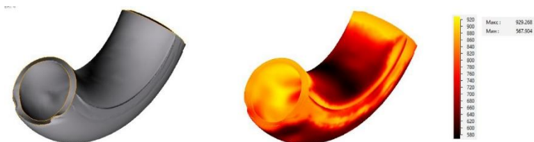
Рис. 2. Общий вид штампованного отвода и распределение температуры
