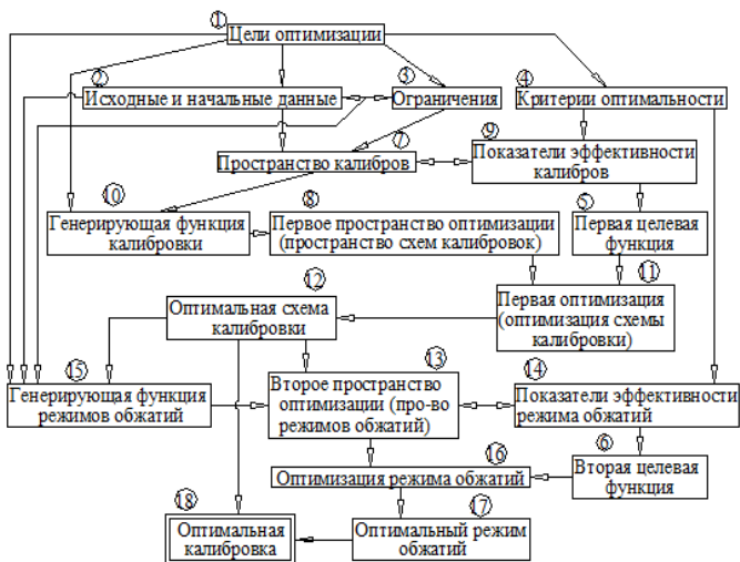
Рис. 1. Блок-схема «Концепции оптимальной калибровки валков» [2]
