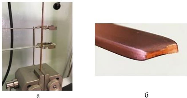
Рис. 1. Образец с экстензометром в захватах испытательной машины (а) и внешний вид образца в месте разрыва(б)
